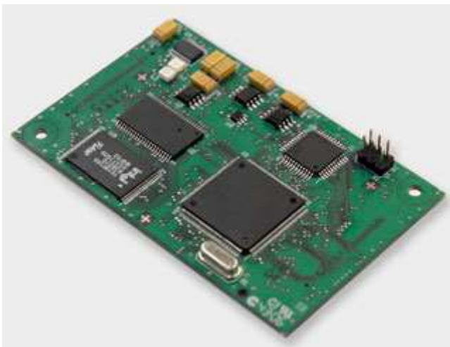
Figura 1 - Vista superior da placa eLPC144
